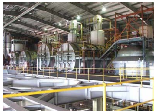
Hình 9: Hệ thống lọc ly tâm của nhà máy
