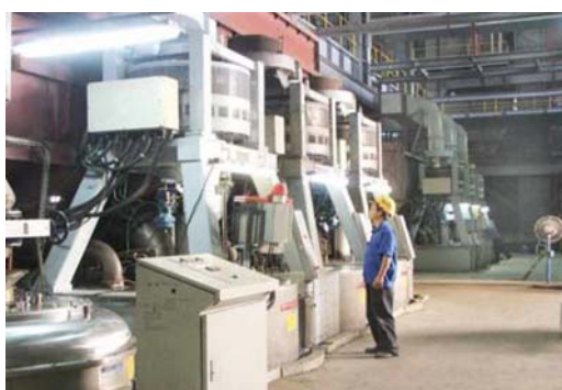
Hình 9: Hệ thống lọc ly tâm của nhà máy
